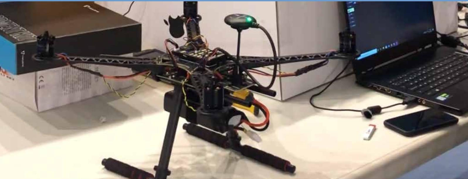
También se tratan las configuraciones de dos de las controladoras de vuelo mas versátiles del mercado: Pixhawk 4 para el multirroto e iNav F35, especialmente valorada para UAS de Ala Fija.
